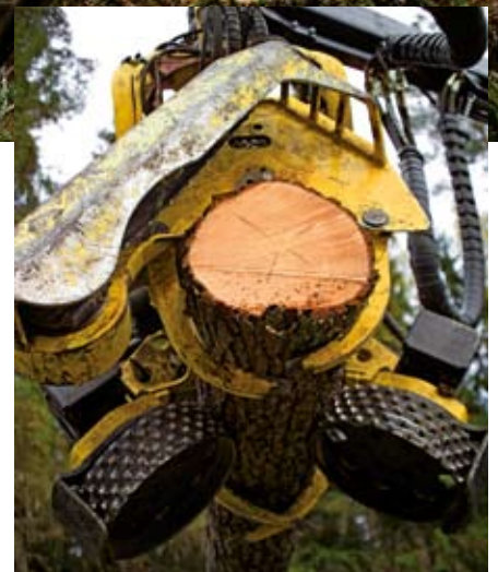
Der Stamm wird hauptsächlich von den Vorschubwalzen getragen.
